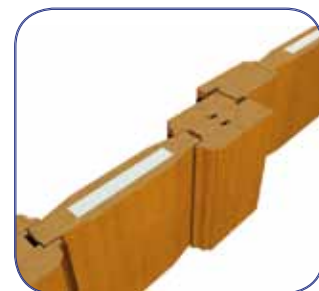
grubość ościeżnicy drzwi zrównana z grubością naświetli
