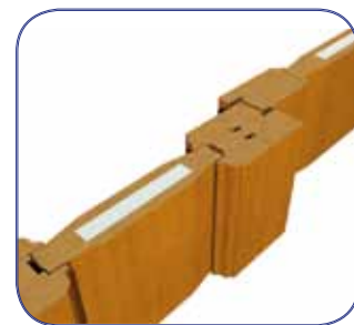
grubość ościeżnicy drzwi zrównana z grubością naświetli
