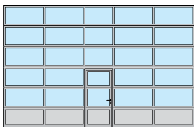
Drzwi przejściowe usytuowane centralnie
